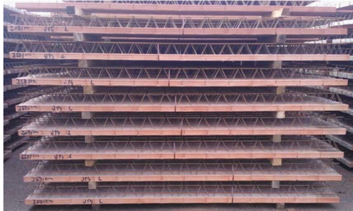
Abb. 8 Richtige Position der Kanthölzer Abb. 7 Beispiel für Stapelung der Deckenträger
