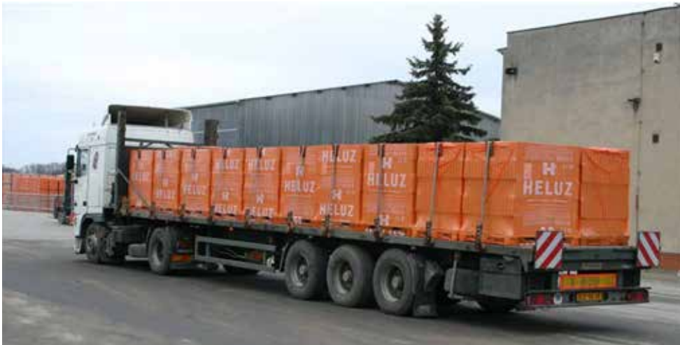
Abb. Ansicht von ordnungsgemäß beladenen Paletten mit Ziegeln auf einem Lastwagen
