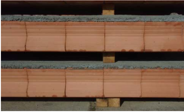
Abb. 10 Erste Platte im Stapel wird mit zwei Kanthölzern unterlegt
