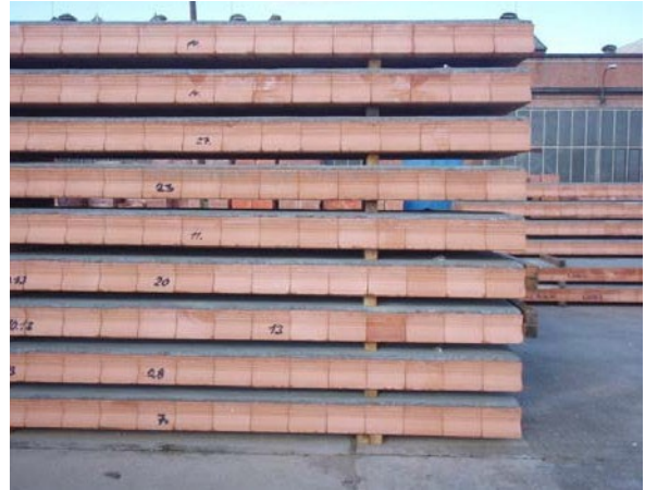
Abb. 11 Kanthölzer zwischen einzelnen Platten werden senkrecht übereinander angeordnet
