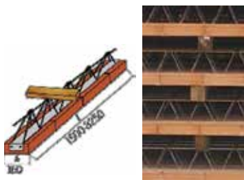
Abb. 8 Richtige Position der Kanthölzer Abb. 7 Beispiel für Stapelung der Deckenträger
