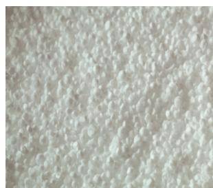
Polystyrol zum Verfüllen
