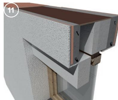
Die Sonnenschutztechnik wird montiert. Durch Einsetzen des Kastens mit Hilfe der am Fensterrahmen verankerten Führungsleisten.
