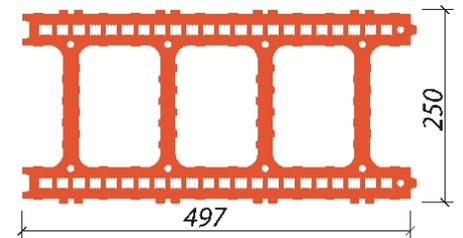
Bewertetes Schalldämmmaß, auf dem mit Kalkzementmörtel ausgemauertem und vergossenem Mauerwerk der min. Rohdichte 1940 kg/m<sup>3</sup>, beiderseitig mit Kalkzementputz 2 x 15 mm, der Rohdichte 1740 kg/m<sup>3</sup> versehen.
